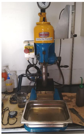
Figura 17. Célula de flutuação Denver utilizada nos ensaios realizados com o minério da mina de Neves-Corvo.
